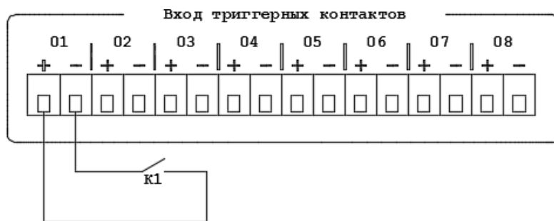
Рис. 2.3. Схема подключения внешних сигналов управления к LPA-DUO без контроля целостности.
